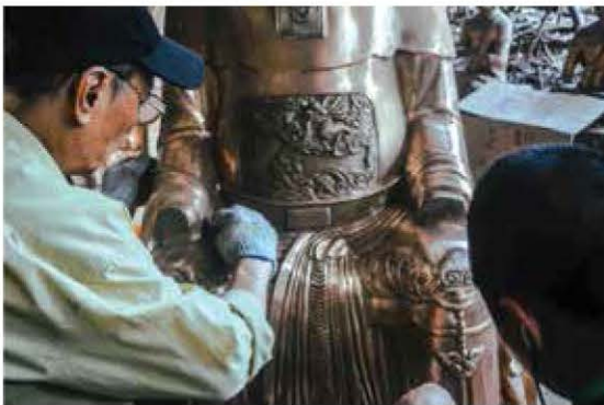
Hình 6.4. Hoàn thiện sản phẩm ở làng nghề đúc đồng Long Điền (Nguồn: thanhphobaria.com)
